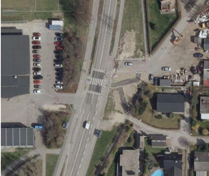
Figur 9. Hævet flade på Skovvej ved Håbetsvej (foto fra Ballerup Kommunes web GIS).
