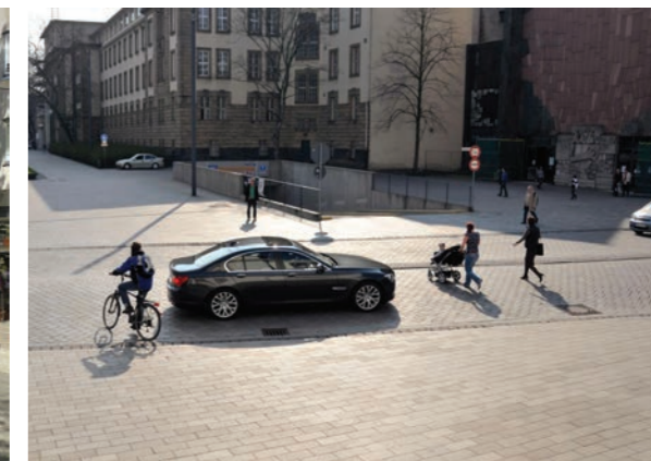
Gennemgående belægning, som naturligt giver hastighedssænkning og tryghed
